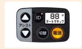
バッテリー残量表示 残り走行時間表示 残り走行距離表示
