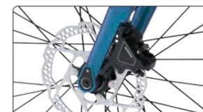
雨天時などでも制動力が落ちにくいディスクブレーキを前後に搭載することで、荒天時でも安定した制動が可能。
