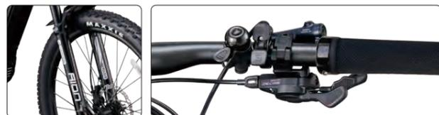
SRサンツアー製AION35 EVO Boostを採用。MTB最新規格の下側1.8(ワンポイントエイト)のテーパコラムを採用した高剛性フロントサスペンションフォークで、150mmトラベルによって高い走破性を実現。路面に合わせてサスペンションの動きを手元のリモートレバー操作でロックできる。
