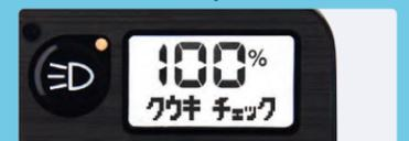
タイヤの変形量からモーターが推定し、空気の入れ時を「クウキチェック」の表示でお知らせ。※3 適正なタイヤ空気圧を保つことで、リム打ちパンクやタイヤ・チューブ劣化を予防し、バッテリー消耗を軽減します。
