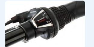
よりスポーティーな走りを実現するギア設定と路面状況に合わせて最適な変速を実現する外装7段変速。
