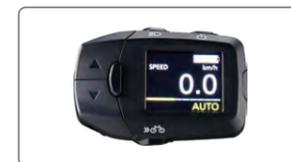
カラー液晶ディスプレイ&操作スイッチは見やすいカラー表示でハンドル左側に集中配置。USB給電<sup>※1</sup>やBluetooth接続ができる。<sup>※2</sup>
