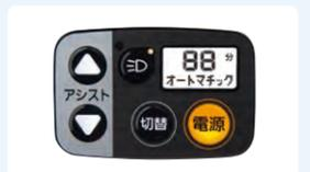
バッテリー残量表示 残り走行時間表示 残り走行距離表示
