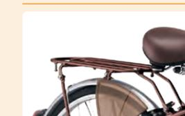
▲ チャイルドシートは取り付けできません。 ▲ 本製品は軽量アルミアキャリアを採用しています。最大積載量18kgを超える積載はお止めください。
