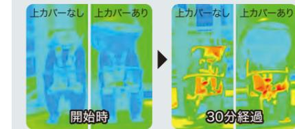
下カバーを外すとサンシェードに最大約27℃の表面温度上昇を抑制
