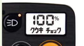
タイヤの変形量からモーターが推定し、空気の入れ時を「クウキチェック」の表示でお知らせ。<sup>※1</sup>
