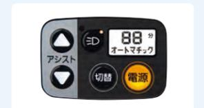
バッテリー残量表示 残り走行時間表示 残り走行距離表示
