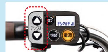
押し歩きアシストの速度を2段階で調整可能。
