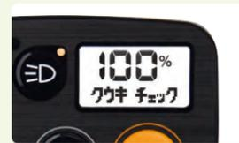
タイヤの変形量からモーターが推定し、空気の入れ時を「クウキチェック」の表示でお知らせ。<sup>※1</sup>
