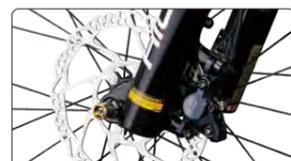
雨天時などでも制動力が落ちにくいディスクブレーキを前後に搭載することで、荒天時でも安定した制動が可能。マウントは前ポストマウント、後フラットマウント、ローター径は前φ180mm、後φ160mm。
