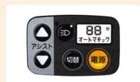
バッテリー残量表示 残り走行時間表示 残り走行距離表示
