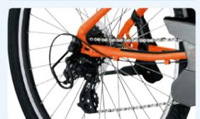
よりスポーティーな走りを実現するギア設定と路面状況に合わせて、最適な変速を実現する外装7段変速。
