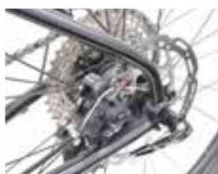
フラットマウントの ディスクブレーキキャリパー
