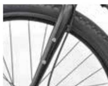
Fフォーク、ダウンチューブ などにダボ穴を用意
